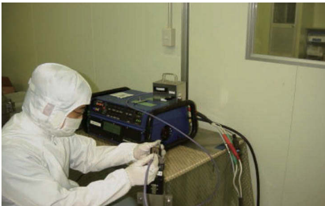
クリーンルーム内での自動溶接作業
