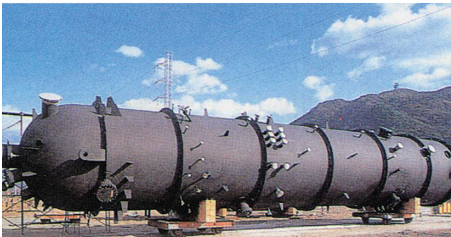
塔（酸化反応器・長さ30m、直径3m、重量70トン）
