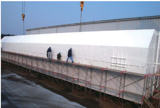
H-II Bロケット輸送コンテナ 形状：6.5m×6.5m×38.0m、重量：60ton
