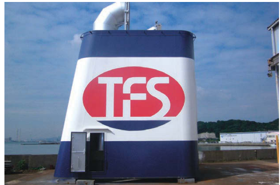
カーフェリー化粧煙突 形状：5.0m×6.5m×7.0m、重量：20ton
